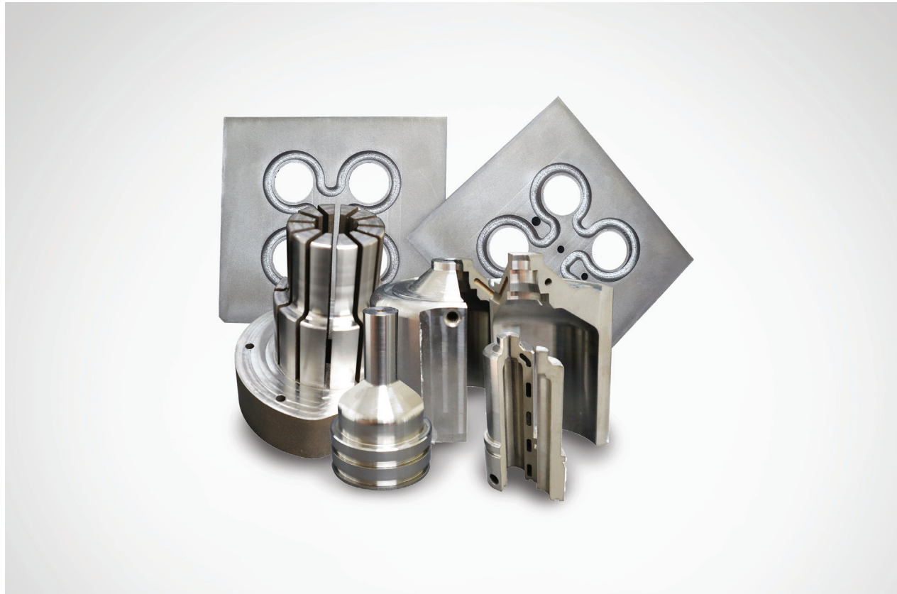
▶ 금형, 스프루 부시의 경우 DMLS 적용 후 2차 CNC 가공으로 제작
